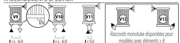
LÉGENDE: ▶ Entrée ▷ Sortie ◀ Purgeur H Hauteur I Entraxe L Largeur □ Manchon ■ Bouchon soudé
